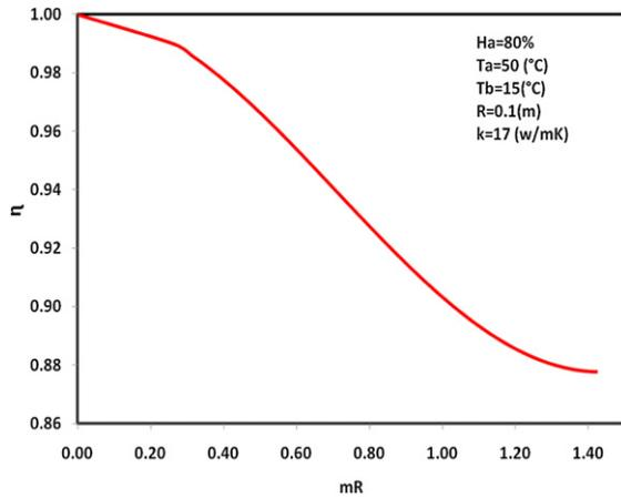
Fig. 4 – Fin efficiency versus the fin parameter (mR).
